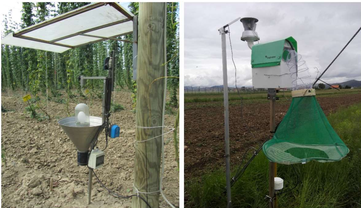
Slika 3: Klasična svetlobna vaba (levo) in avtomatska svetlobna vaba Trapview AURA (desno) z dodanim mrežastim stožcem in feromonom za spremljanje metuljev koruzne vešče (Foto: Arhiv IHPS)
