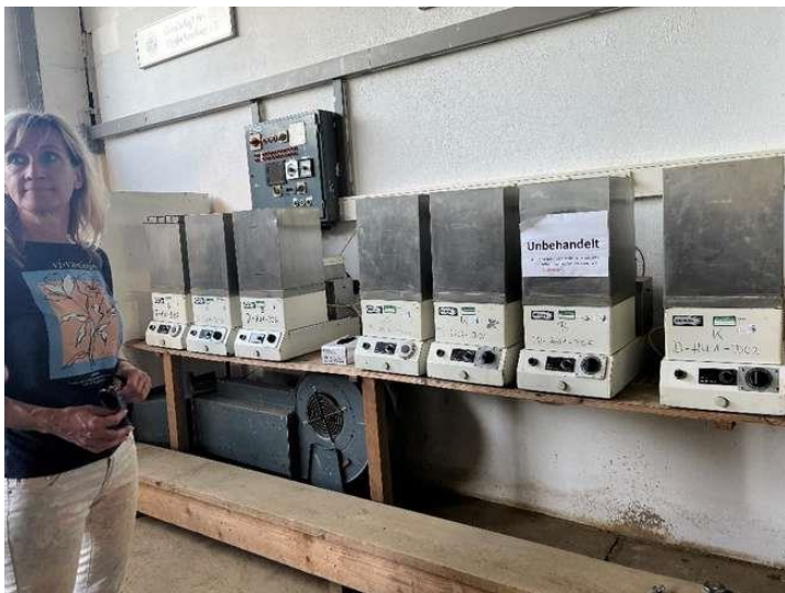
Slika 14: Mikro sušilnice za vzorce hmelja.
