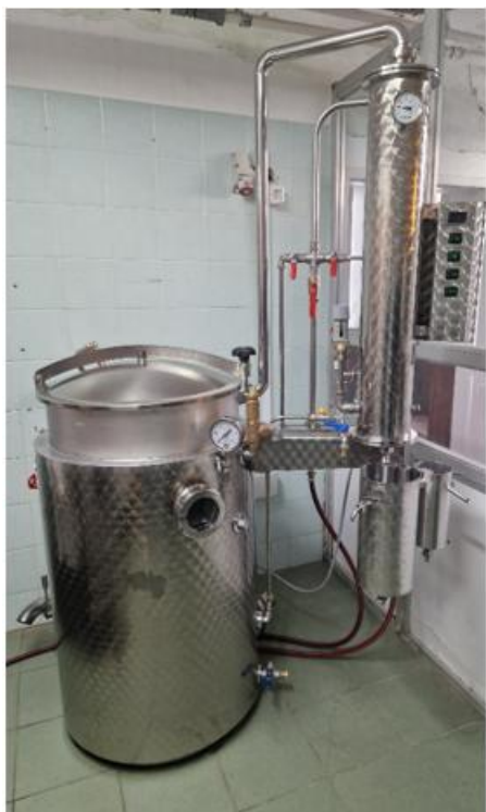
Slika 9, levo: Destilacijski sistem za pridobivanje eteričnih olj in hidrolatov / Distillation system for extracting essential oils and hydrolates
