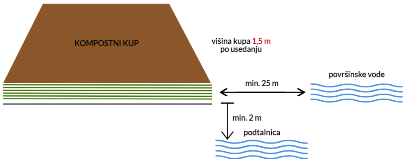
Slika 7: Shema postavitve kompostnega kupa (skico zrisala: J. Polanšek)
