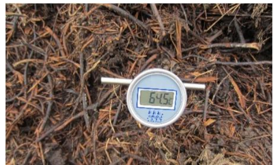
Slika 10: Vbodni termometer in prikazovalnik vbodnega termometra (Foto: L. Luskar)
