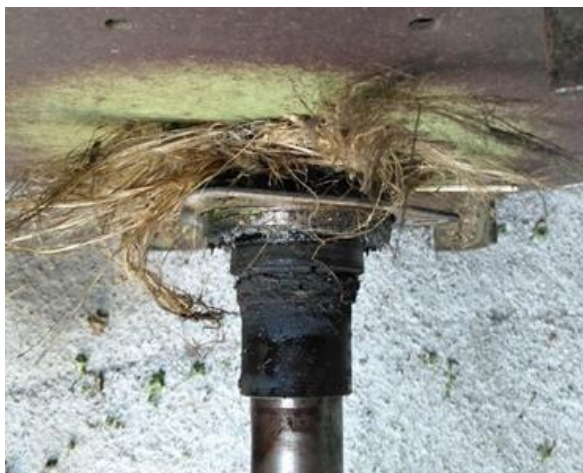
Slika H12: Navijanje vlaken na vležajenju
