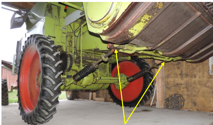
Slika H5: Kolesa večjega premera in spremenjena prijemališča hidravličnih cilindrov.
