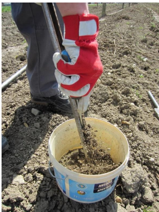
Slika 4: Podvzorec postrgamo iz sondine zareze v čisto vedro s palico ali izvijačem
