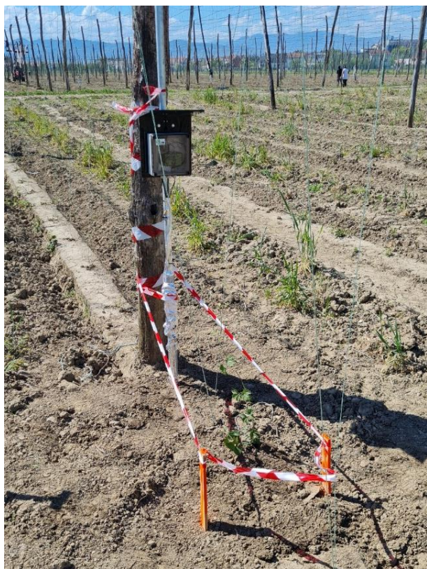
Slika 27: Komunikacijske napravo (data logger) z baterijo in sončno celico za napajanje baterije ter vstavljenimi senzorji za spremljanje količine vode v tleh.
